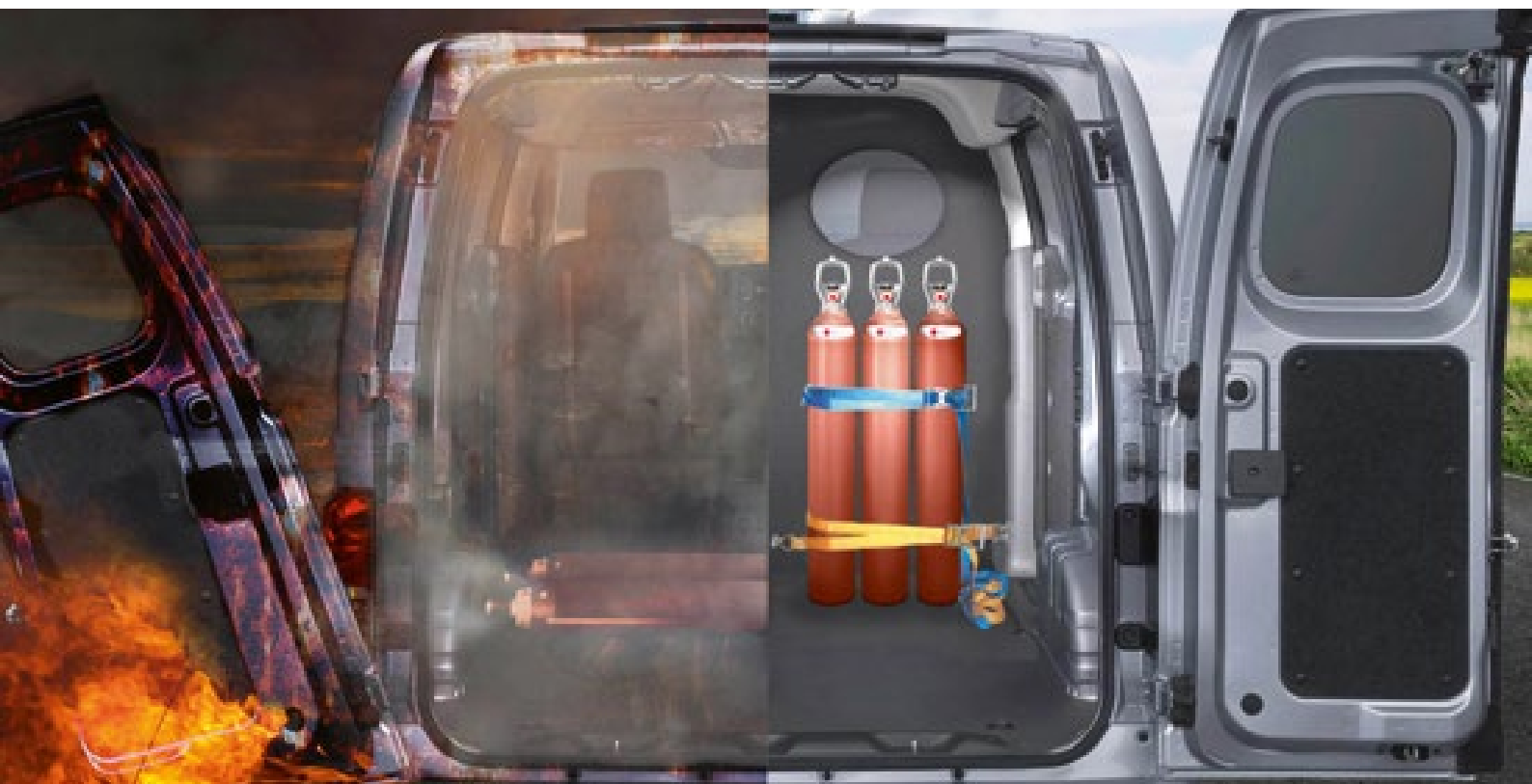
Billedet viser hvordan flasker skal transporteres i bil. De skal være fastgjort så de ikke kan vælte.
